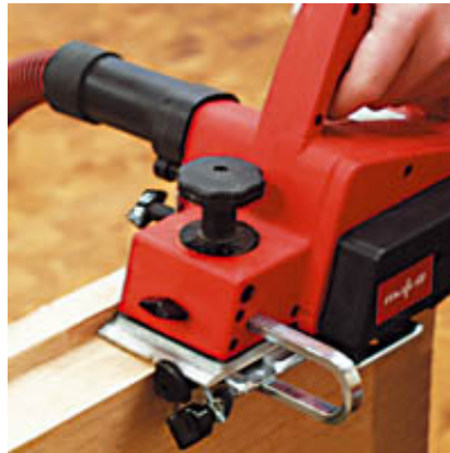
Nachfalzen einer Tür mit dem MHU 82.
