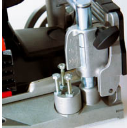
Randabstand-Einstellung über Revolver-Anschlag oder über Skala.
