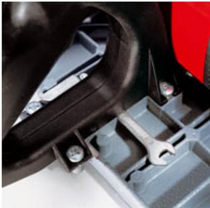
Das Werkzeug für den Messerwechsel befindet sich direkt an der Maschine.
