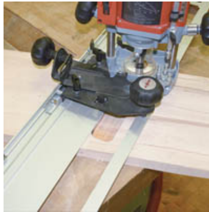
Das Treppenwangen-Fräsergerät im Sonderzubehör für Ausfräsungen von 640 x 60 mm.
