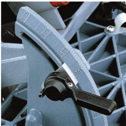
Exakte Verstellung des Neigungswinkels mittels stabiler Klemm-Arretierung.
