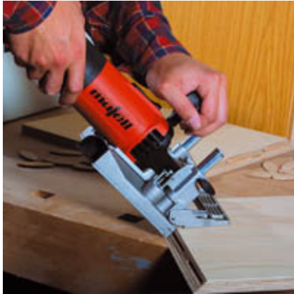
Verbindungen auf Gehrung mit der LNF 20.
