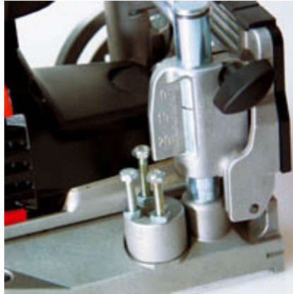
Randabstand-Einstellung über Revolver-Anschlag oder über Skala.
