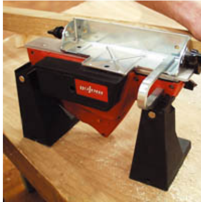
Einhandhobel MHU 82 mit stationärer Einrichtung und Pendelschutzhaube.
