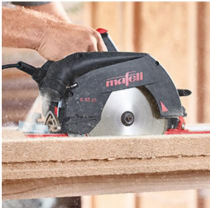
Die Spanführung wurde für das Schneiden von Holzfaserverwerkstoffen konzipiert und optimiert. Auch bei Tauchschnitten in Faserrichtung bietet die herausragende Spanführung erhebliche Vorteile.
