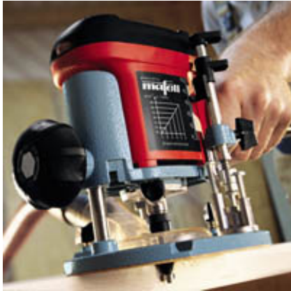
Profilierungen mit dem Anlaufring-Fräser.
