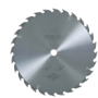
Sägeblatt-HM 410 x 2,5/4,2 x 30 mm, Z 28, WZ, für universellen Einsatz in Holz (MKS 165 Ec)
