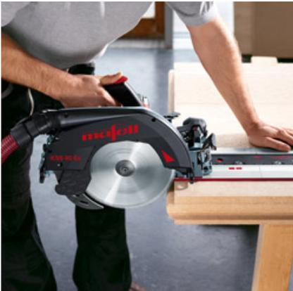
Die KSS 80 Ec / 370 kann einfach und schnell von der Systemschiene getrennt und auf eine bestehende Führungsschiene aufgesetzt werden.
