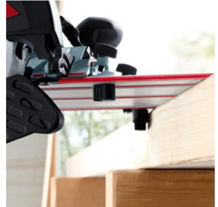
Der fixe und der einstellbare Anschlag an der Unterseite der Schiene sorgen dafür, dass das System für Winkelschnitte von  $+50^\circ$  bis  $-60^\circ$  eingesetzt werden kann.
